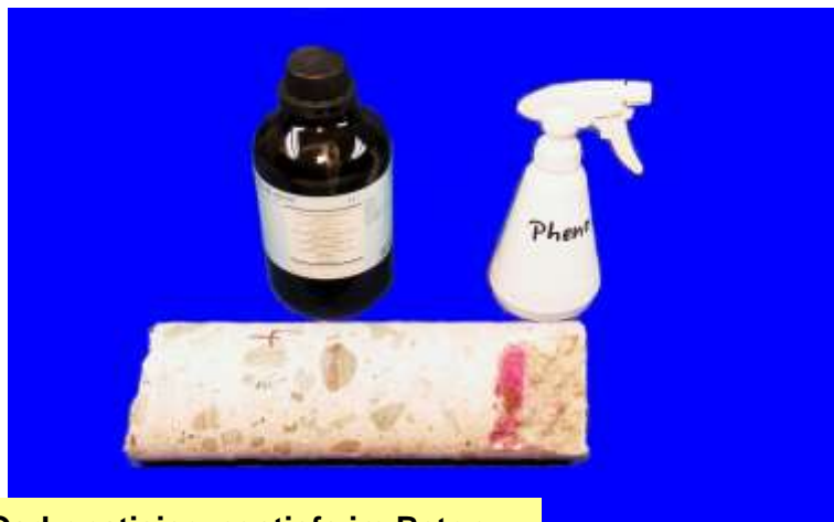
Messung der Carbonatisierungstiefe im Beton
