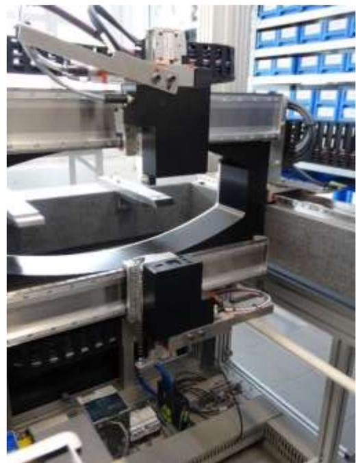
Zur Vermessung stehen zwei Messprogramme zur Verfügung. Im Standard-Messprogramm werden alle Kriterien komplett vermessen wie auf der Grossanlage, wo die Kapseln Batchweise vermessen werden. Die Messzeit pro Kapsel beträgt etwa 20 Sekunden. In Schnell- Messprogramm wird eine Kapsel möglichst schnell Vermessen. Die Zeit zur Vermessung der minimal notwendigen Daten liegt bei etwa 4 – 5 Sekunden pro Kapsel.
