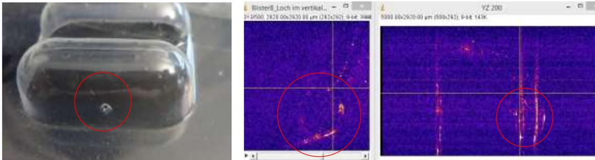
Beschädigungen, Risse oder Kratzer lassen sich mit dem OCT Verfahren klar lokalisieren und identifizieren. OCT- Systeme liefern deutliche Signale im Einsatz an transparenten Bauteilen, wie z.B. bei der Prüfung von Blisterschalen.
