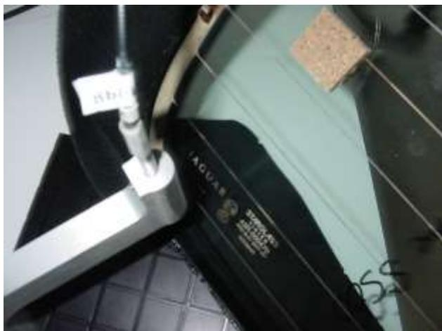
Die Ankopplung kann von Hand oder mit einer mechanischen Halterung erfolgen. Im Gegensatz zum Standard- OCT System das eine Fläche misst, werden mit dem Faser- OCT System einzelne Punkte vermessen.
