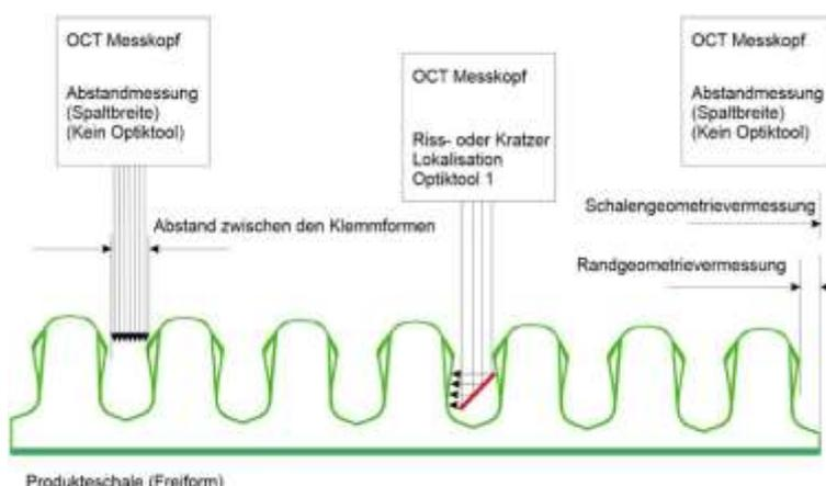
Mit der OCT- Methode werden auch die Clipdeckel oder Kanten von Einlegeschalen exakt vermessen oder überprüft. Auch Geometrische Abstände zwischen zwei definierten Ebenen oder Strukturen werden mit dem OCT- System exakt (im Sub-Mikrometerbereich) vermessen. Zur Vermessung stehen verschiedene optische Module zur Verfügung.
