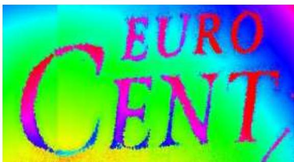
Die Höhenwerte von jedem Bildpunkt ergeben eine exakte dreidimensionale Rekonstruktion der Oberfläche.
