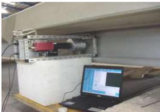
Dazu wurde die PT-RT- Methode eingesetzt, weil mit dem Verfahren keine Berührung zum Objekt bestehen muss.
