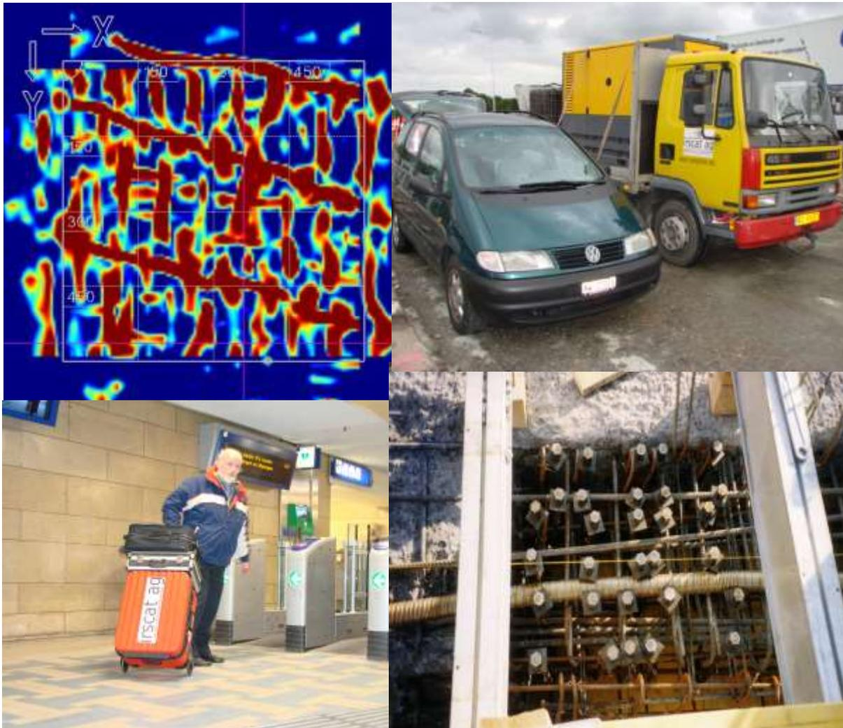
Modernste Ortungsgeräte lokalisieren alle Einbauteile. Ob Stahlleitungen, Kupfer- oder Kunststoffrohre, Hohlräume, Spannkabel oder Wasserleitungen. Mit modernen Verfahren können Einbauten genau erkannt und vermessen werden damit Schaden vermieden wird.
