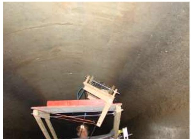
In Firstbereich wurden je 4 Profile mit den zwei Antennen abgefahren. Aufgrund verschiedener Unzulänglichkeiten (Bohrtrupp konnte nicht ausweichen, Graben im Kanal, Stromversorgung mit Verbrennungsmotore) mussten alle Einrichtungen mehrmals ausgebaut und wieder neu eingebaut werden.
