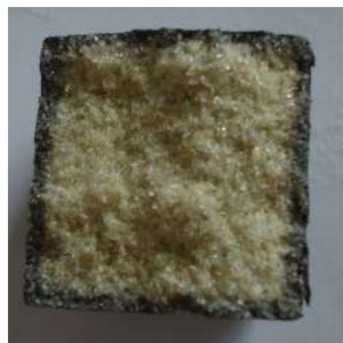
Aus den Messungen ergibt sich das „Einsinkverhalten“ einer Beschichtung. Die erste Messung liefert die Oberfläche der Beschichtung. Die folgenden Messungen zeigen jeweils die Oberfläche der Beschichtung, deren Lage sich aufgrund des
