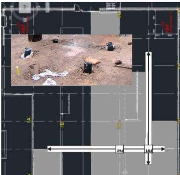
Nur wer weiss, wo die Pfähle unter der Bodenplatte in einem Industriebau liegen, kann die zulässige Belastung des Bodens oder die Auswirkungen auf die Statik des Bauwerks ableiten.
