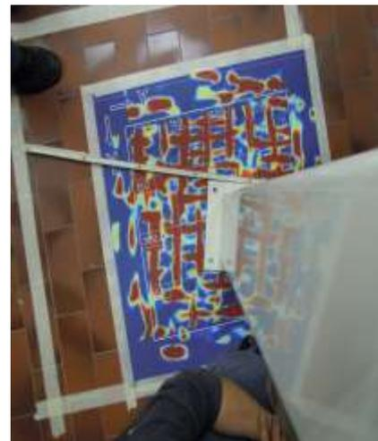
Durch das Tomogramm (Volumenbild) bei jeder Stütze konnte der Verlauf aller Einbauten im Boden bis zu einer Tiefe von 30 cm sichtbar gemacht werden. Mit Hilfe der Fixierung der Referenzpunkte und der exakten Vermessung ist bei jeder Säule klar, an welcher Stelle sicher gebohrt werden kann. Der Montageingenieur kann nun die Grundplatte der Säulen so bestimmen, dass die Löcher dort sind, wo kein Schaden eintritt. Dazu dient die massgetreue Vorlage.
