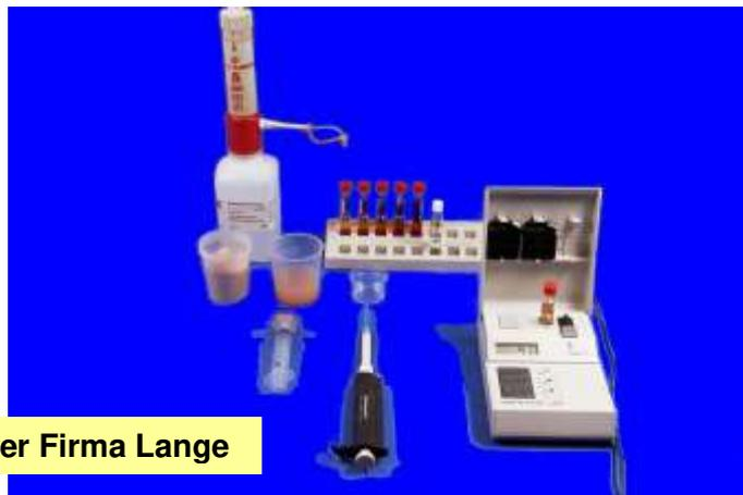
Photometer der Firma Lange
