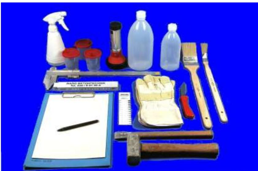
Utensilien die für den Prüfer zur Ausrüstung gehören. Sie dienen dem Auffinden von Fehlstellen in Bauteilen.
