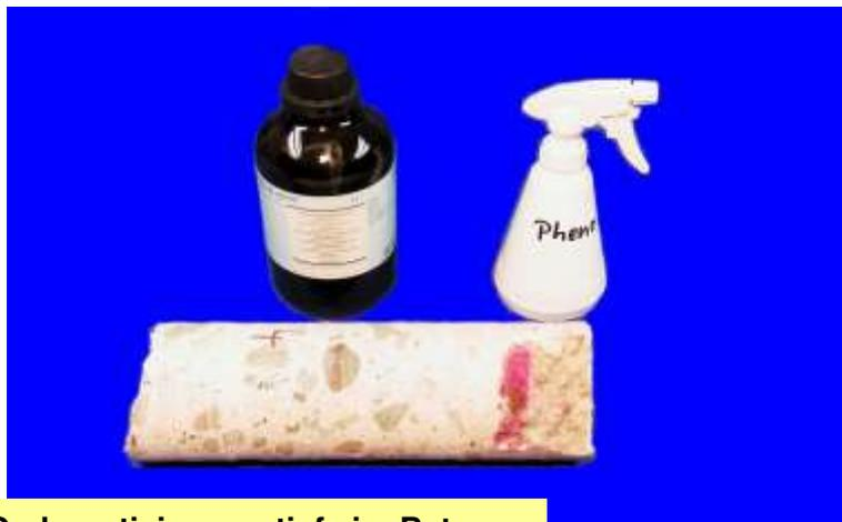
**Messung der Carbonatisierungstiefe im Beton**
