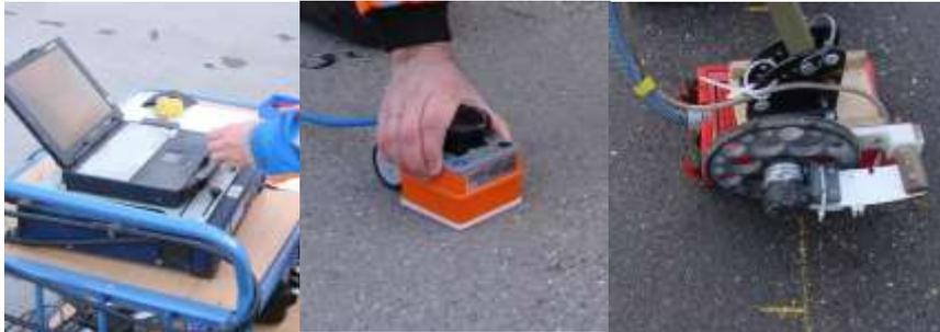
Aufzeichnungseinheit (Links) und die verschiedenen Antennen. Je kleiner die Antennen umso höher die Arbeitsfrequenz, je höher die Arbeitsfrequenz je geringer ist die Eindringtiefe im Bauteil. Die Auswertung der erfassten Signale erfolgt über eine spezielle Auswertesoftware.
