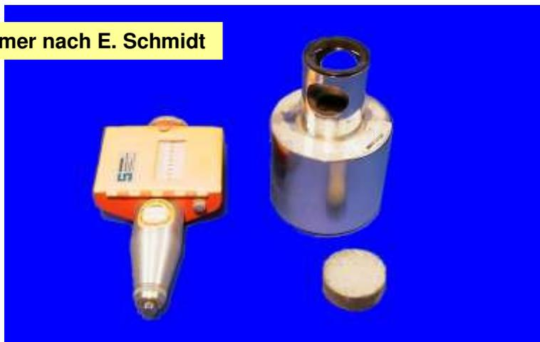
DIN 1048 beschreibt die Prüfung mit dem Rückprallhammer nach E. Schmidt in Teil 2 und Teil 4. Sie darf nur mit dem Modell N durchgeführt werden.
